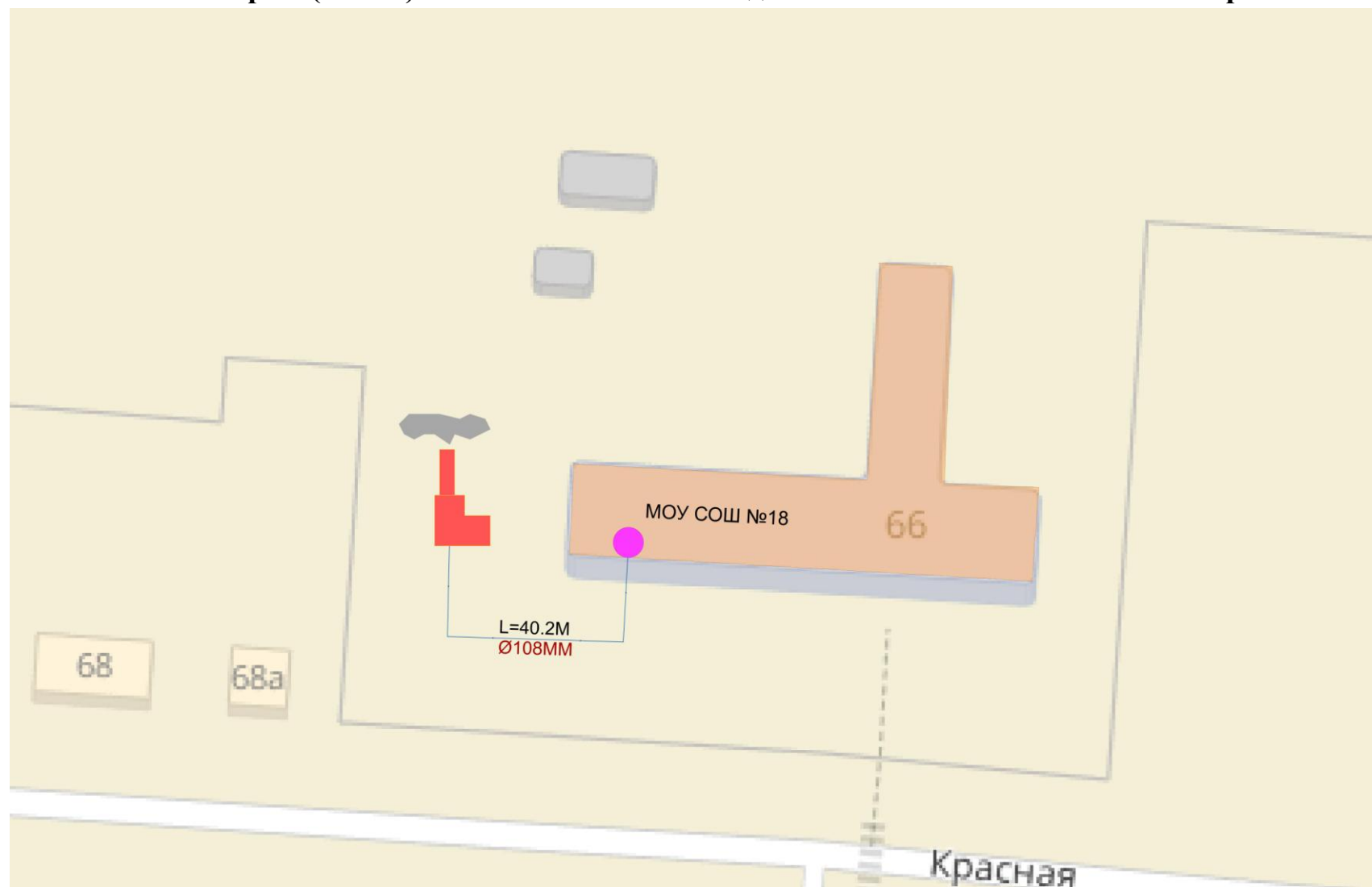
Рис. 1. Схема тепловых сетей котельной ООО «Усть-Лабинскгазстрой»
